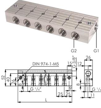
**Werkstoffe:** Körper: Aluminium eloxiert, Kugel und Spindel: Messing verchromt, Dichtungen: PTFE/NBR
