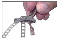
...Hand-Spannchloss einhängen und ca. 3cm hinter das Hauptband zurücklegen...
