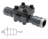
Selbstentleerung: 3° - 6° zur Durchflussrichtung geneigt und 25° - 33° zur Waagerechten gekipp
